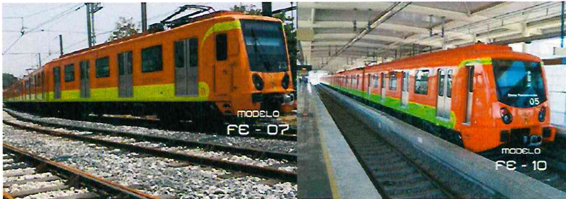
Figura 1.3 Laminado a base de acero de las series FE-07 y FE-10 fabricado por CAF. La FE-10 es operada en la L12 por STC
