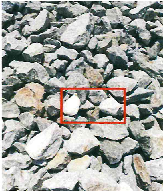
Figura IV.1.24 – Detalle de Balasto
