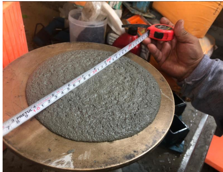
Columna 275. Prueba de fluidez - resultado 88%.
