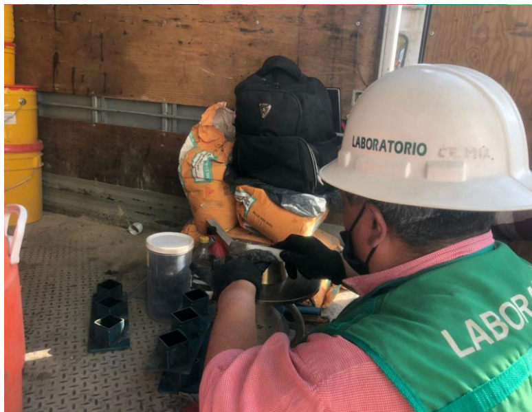
Columna 273. Prueba de fluidez- resultado 84%.
