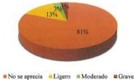
**Figura 5. Clasificación de deficiencias o daños observados en soldaduras**
