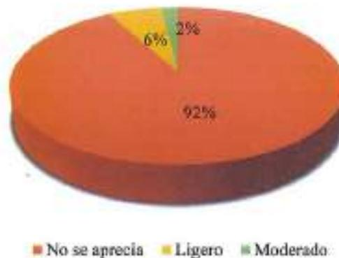
**Figura 7. Clasificación de traves principales deformadas**
