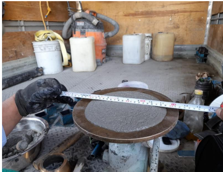
Toma de lectura para determinar la fluidez de la mezcla de Grout.
