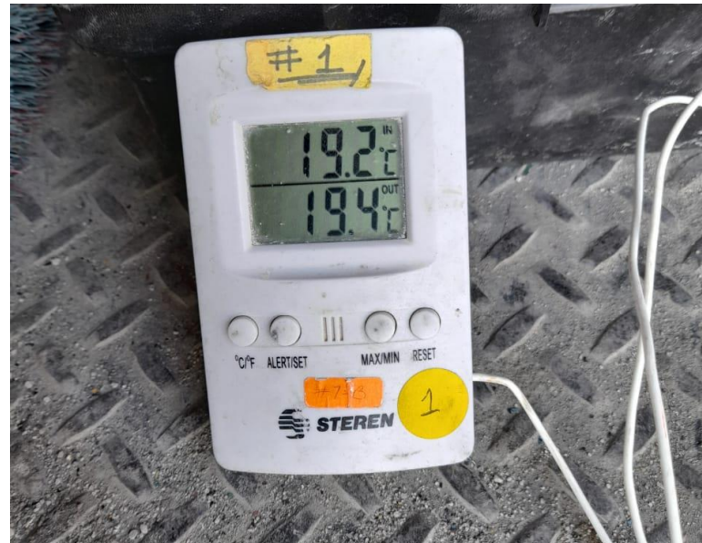
Revisión de condiciones ambientales antes del colado.
