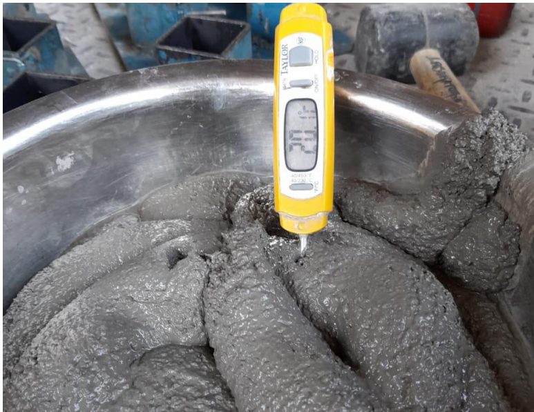
Temperatura de la mezcla de Grout – 20 grados Celsius.
